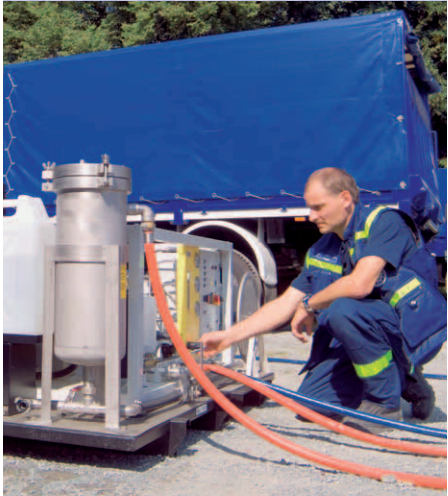
Mit der Umkehrosmoseanlage kann Salzwasser zu Trinkwasser aufbereitet werden.
